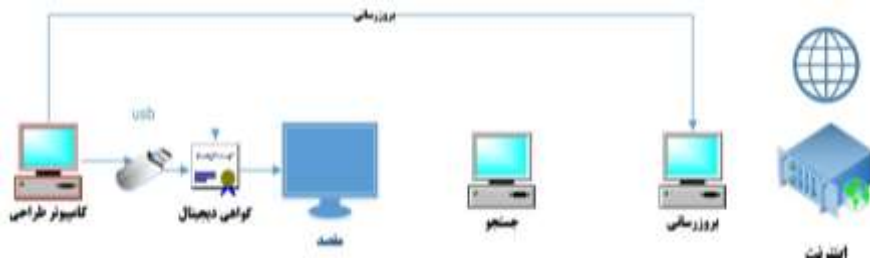
شکل ۳: مکانیسم عملکرد استاکس‌نت در مرحله استقرار
